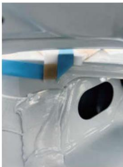
图2 黑车顶分界线胶带压紧工具与PVC粗密封胶干涉风险区域
